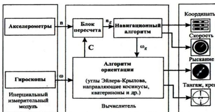
Рисунок 1.3 - Принципиальная блок-схема БИНС
